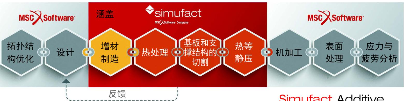
Simufact Additive 涵盖制造工艺链的核心部分，其中包括
