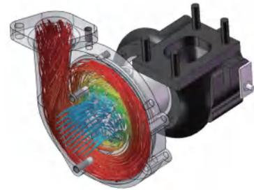
汽车涡轮增压器模拟
