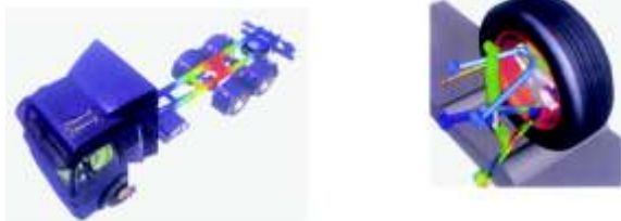
刚柔耦合整车模型平顺性分析
